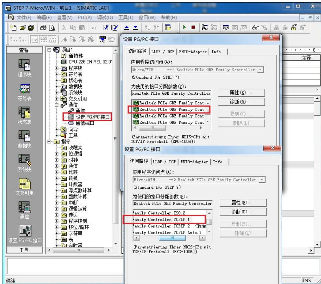
2. 在下图中双击[通信]，在“远程：”框中填入 ETH-PPI 的 IP 地址，如 192.168.1.10，然后点击确认
